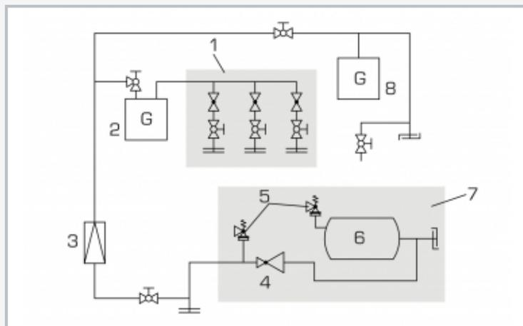
Esquema de procesos: 1 sección de tubo simulación de fugas, 2 contador de gas, 3 regulador de presión de gas, 4 regulador de aire comprimido, 5 válvula de seguridad, 6 depósito a presión, 7 alimentación en aire comprimido, 8 contador de gas
