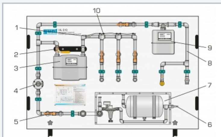
1 sección de tubo simulación de fugas, 2 grifo de bola, 3 contador de gas con 2 tubuladoras, 4 regulador de presión de gas, 5 grifo de bola, 6 toma de aire comprimido, 7 alimentación en aire comprimido, 8 sección de tubo con enchufe de gas y toma de gas con grifo de bola, 9 contador de gas con 1 tubuladora, 10 válvula
