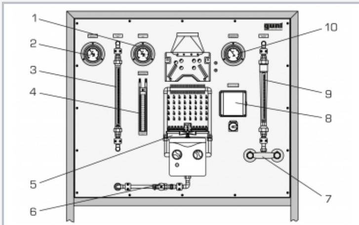
1 presión de gas, 2 presión de agua de entrada, 3 rotámetro de gas, 4 manómetro de tubo en U, 5 calentador de gas instantáneo, 6 válvula principal de gas, 7 mezclador, 8 pulsadores para la simulación de fallos, 9 rotámetro de agua, 10 presión de agua de salida
