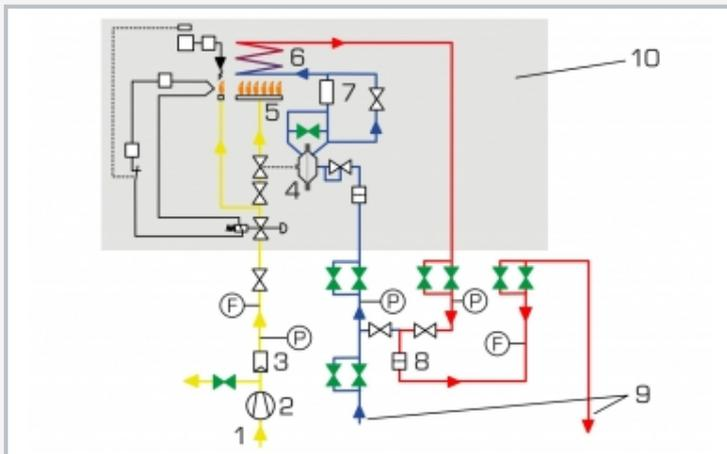
Esquema de proceso: 1 entrada de gas, 2 bomba de diafragma, 3 regulador de presión de gas, 4 regulador de cantidad de gas, 5 quemador, 6 cambiador de calor, 7 tobera Venturi, 8 mezclador, 9 entrada y salida de agua, 10 calentador de gas instantáneo; amarillo: tubería de gas, azul: agua fría, rojo: agua caliente, verde: válvulas para la simulación de fallos
